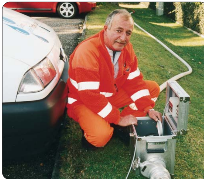
Josef Odermatt erklärt die Funktionsweise des mobilen Messkoffers, mit dem Druckunterschiede entdeckt werden.
