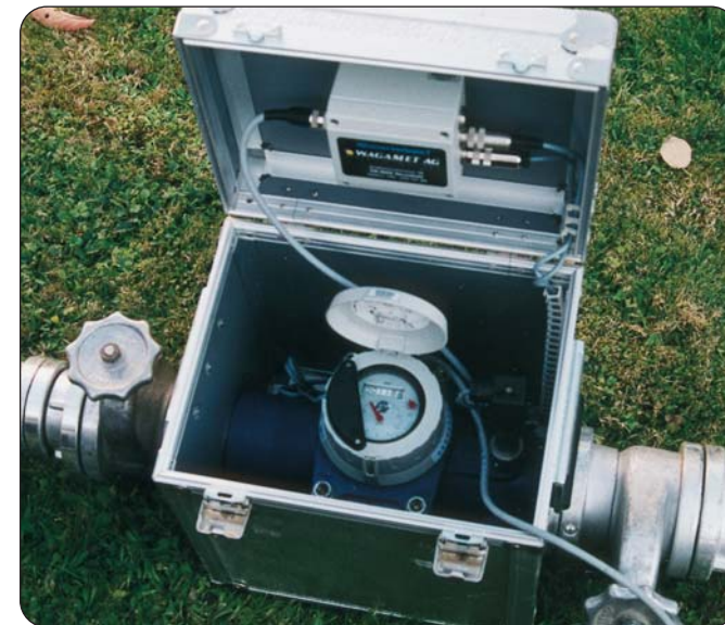
Detailansicht des mobilen Messkoffers mit eingebautem Zähler und dazugehöriger Messelektronik.
