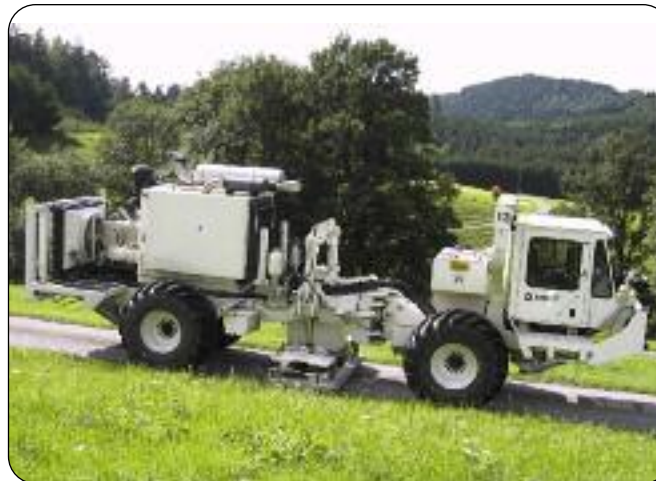
Erkunden von August bis Oktober den Untergrund mit seismischen Messungen: Vibrofahrzeuge.
